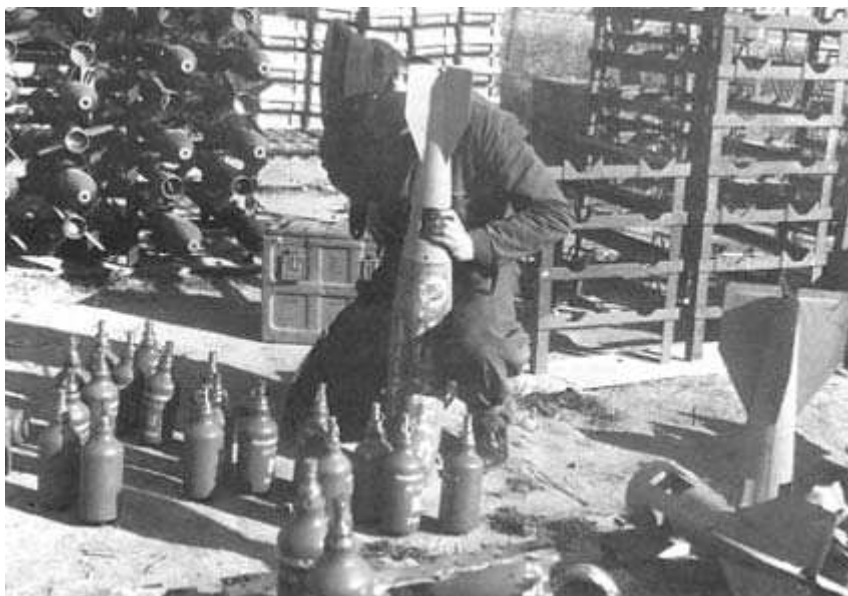
Armurier effectuant le montage de bombes de 500Kg (ECPA)
